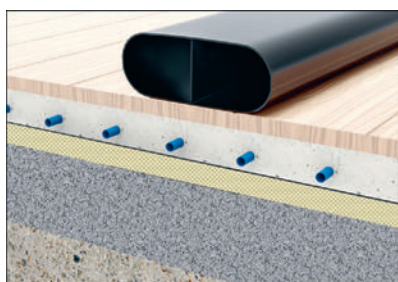
Ploché potrubí v podlahové krytině
